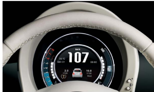
Цифрова РК-панель приладів TFT з кольоровим дисплеєм 7"
